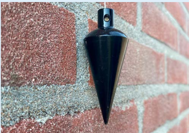
Figuur 26: Schietloodmeting (BVL)
