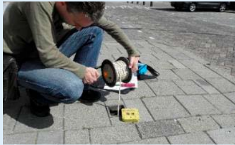
Figuur 31: Grondwaterstandsmeting in een vast buis (Gemeente Rotterdam)
