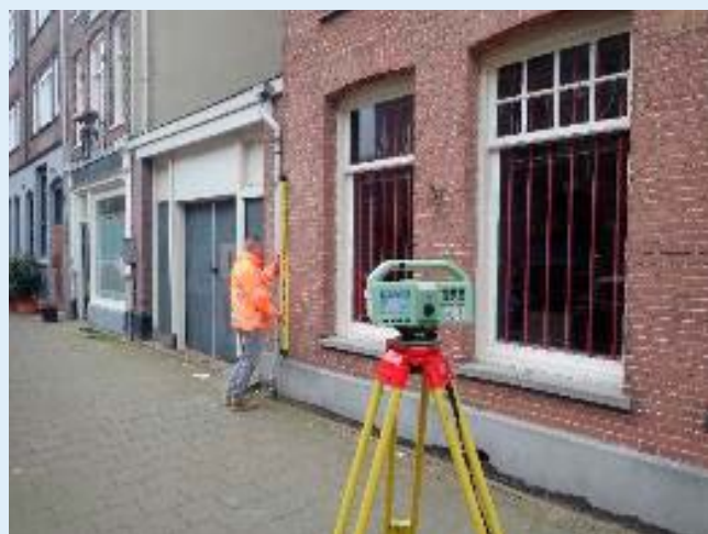
Figuur 29: Hoogtemeting NKW-Bout met Invar-baak (Fugro)
