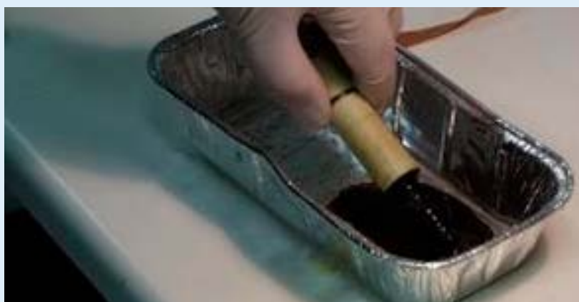
Figuur 53: Boormonsters uit het buisje voor laboratoriumonderzoek (SHR)
