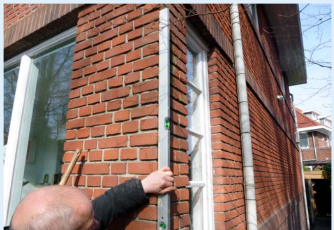
Figuur 27: Loodmeting (BVL)
