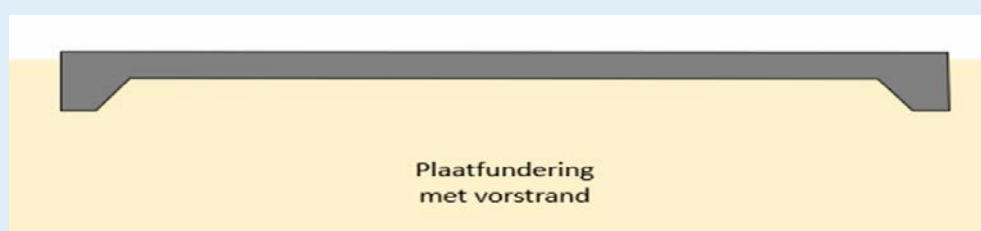
Figuur D1: Plaatfundering (met vorstrand, KCAF)
