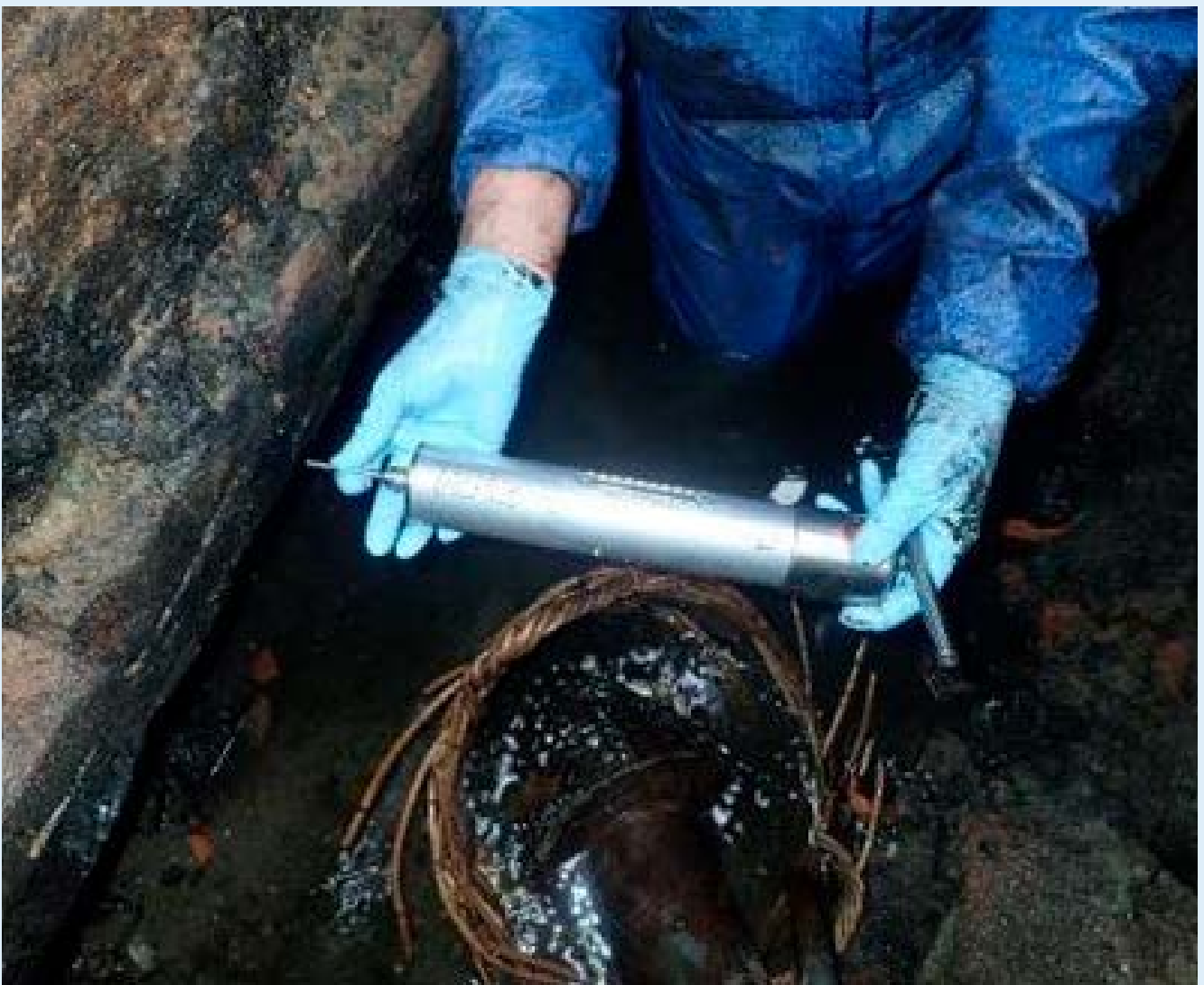
Figuur 48: Meting met inslaghamer (bij niet verontreinigde grond) (BVL)
