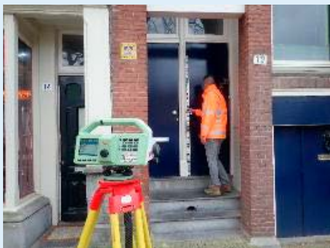
Figuur 28: Peilmaat op kozijndorpel voordeur (Fugro)
